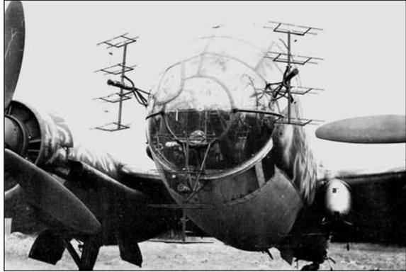
**Si notino, nella vista frontale dello Junkers, le tre grosse antenne del radar Fug 200**
